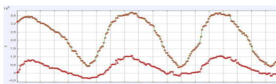
Figura 2: Gráficos del Desplazamiento vertical (arriba) y horizontal (abajo) de la estructura realizadas con el Tracker siguiendo el movimiento de una luminaria del puente
